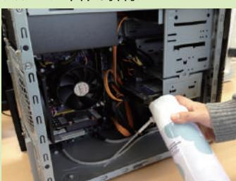
パソコン本体内部の掃除には、エアダスターを使いホコリ取りをしましょう。基盤などの機器に直接吹きかけないように気をつけてください。
